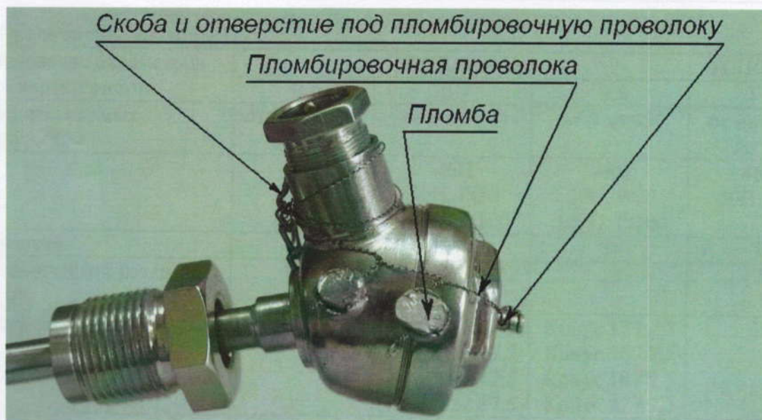
Рисунок 2 – Схема пломбирования термометров сопротивления с металлическими головками
